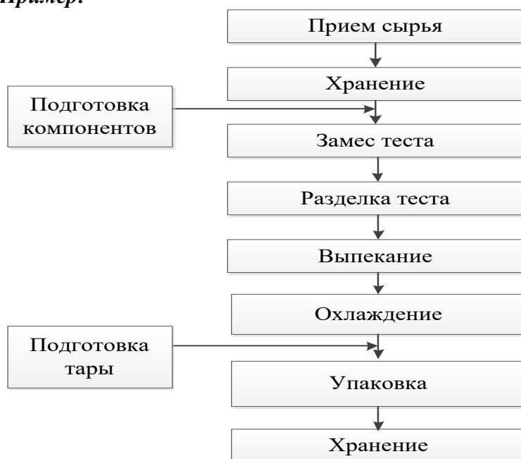
Рисунок 3.2 – Технологическая схема производства сдобных изделий
