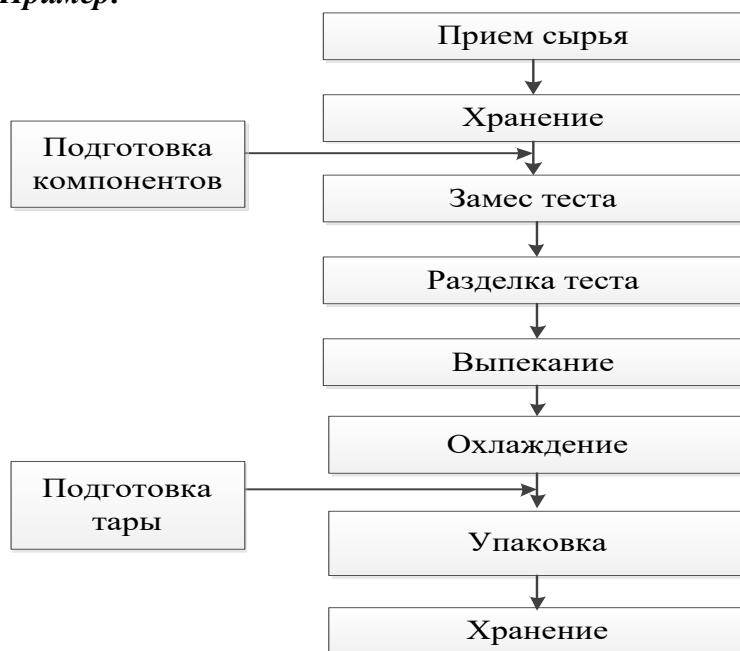
Рисунок 3.2 – Технологическая схема производства сдобных изделий
