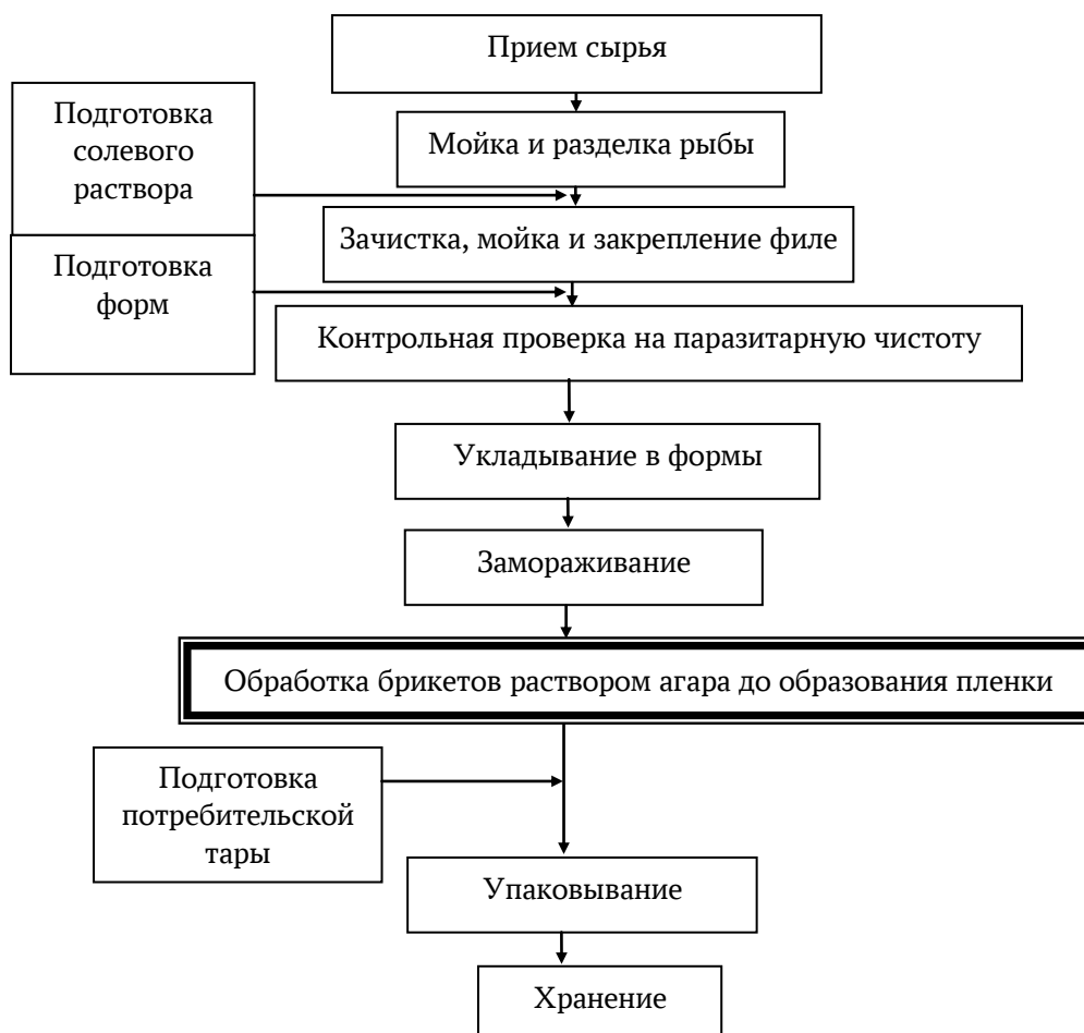
Рис. 4. Технологическая схема производства филе трески мороженого с применением барьерных покрытий на основе агара
