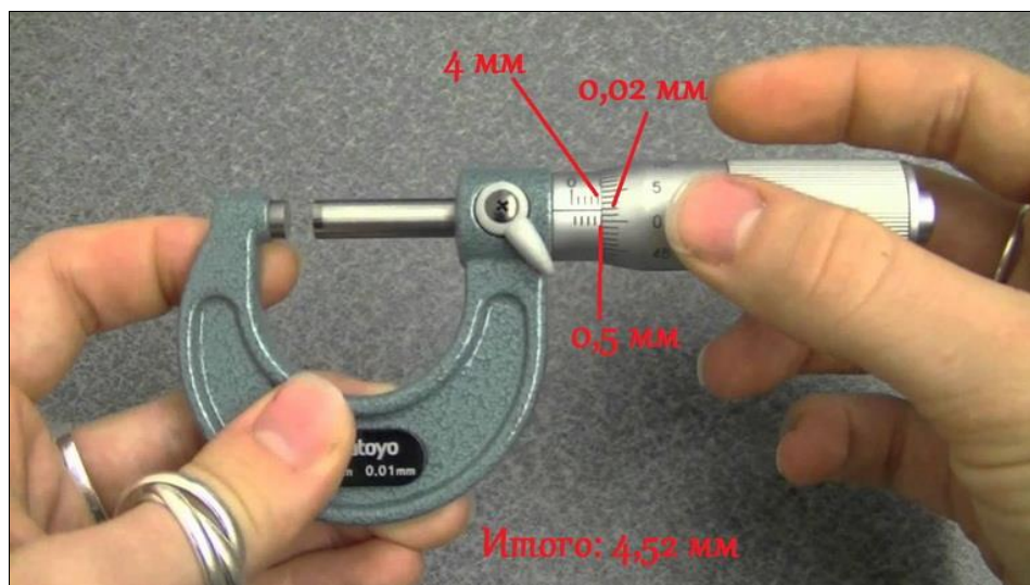
Рисунок 4.11 –Пример вычисления микрометром
