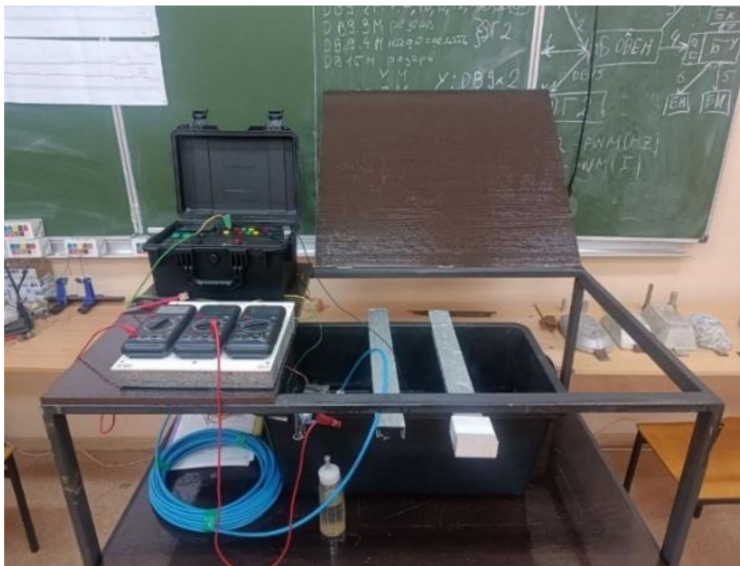
Рис. 1. Общий вид автоматизированного устройства для неразрушающего контроля технического состояния протекторов морских судов
