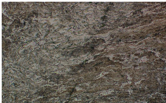
Рис. 1. Сталь А400 при 240 x вдоль стержня арматуры (неравномерное чередование полос второй фазы и феррита, состоящих преимущественно из деформированных зерен)
