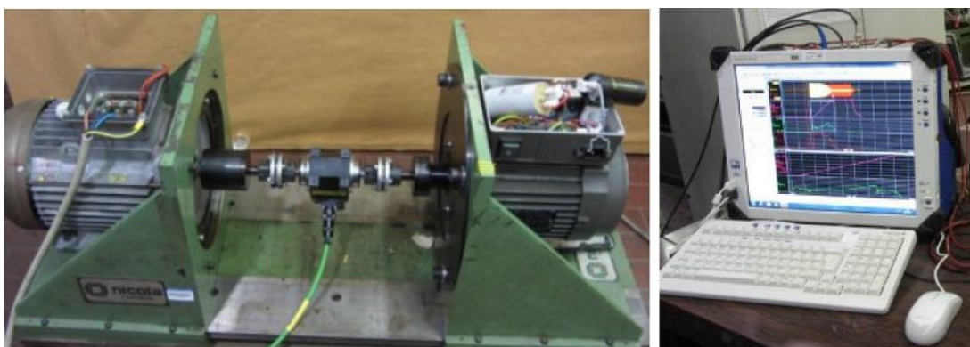
Рис. 1. Испытательная установка НВК для асинхронного двигателя, включающая испытуемую машину, нагрузочный двигатель, датчик крутящего момента и систему сбора данных
