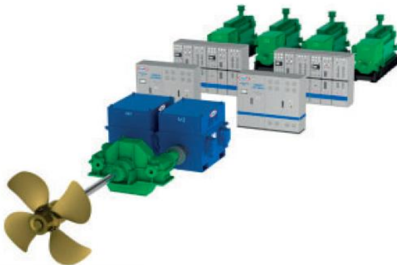
Рис. 2. Состав дизель-электрической установки
