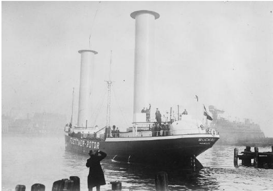
Рис. 1. Первое судно, оснащенное роторами Флеттнера
