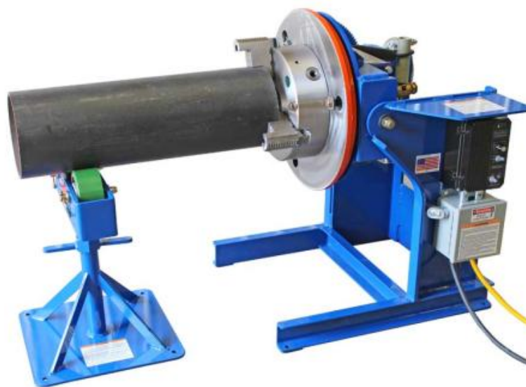
Рис. 1. Крепление детали в сварочном позиционере
