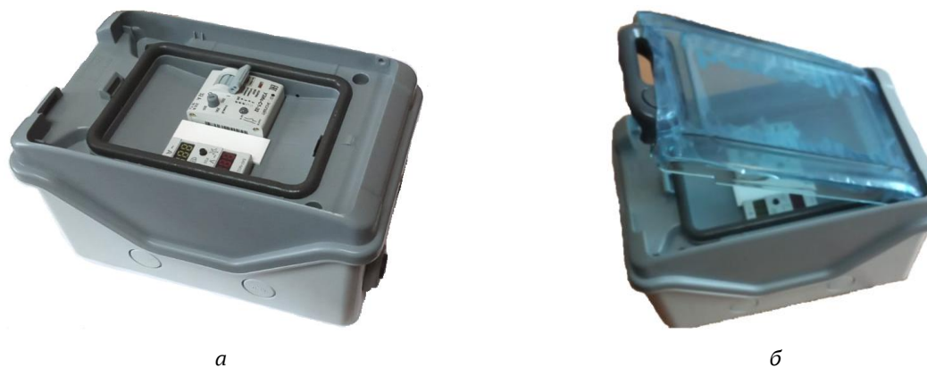
Рис. 2. Внешний вид переносных блоков обнаружения электрической дуги без крышки (а) и с прозрачной крышкой (б)
