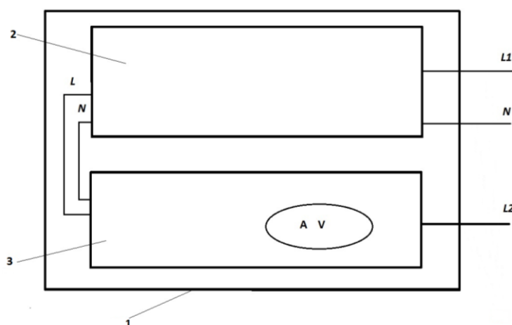
Рис. 1. Схема переносного блока обнаружения электрической дуги
