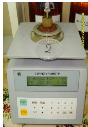
Рис. 2. Измерение усилия, необходимого для разрушения икринки, на структурометре СТ-1М
