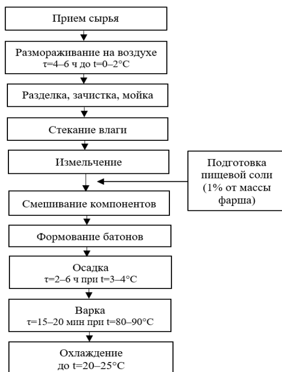
Рис. 1. Технологическая схема приготовления экспериментальных образцов продукта на основе спроектированных фаршевых композиций
