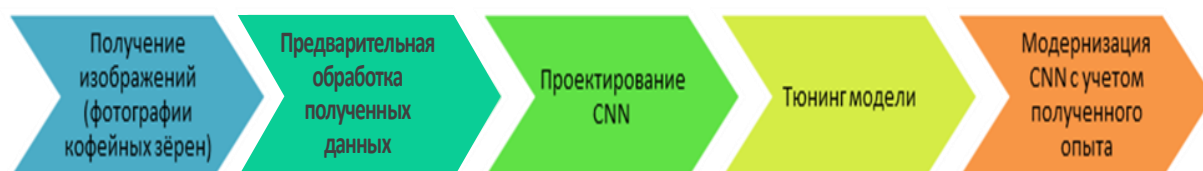
Рис. 2. Схема процедуры подготовки сверточных нейронных сетей (CNN) для проведения визуального анализа
