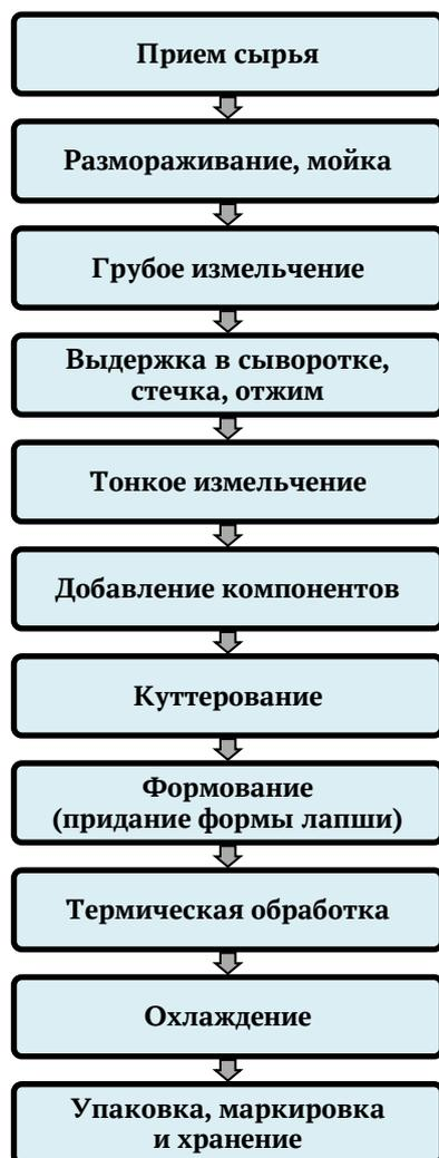
Рис. 7. Технологическая схема производства формованных изделий, имитирующих макаронные, из фарша минтая
