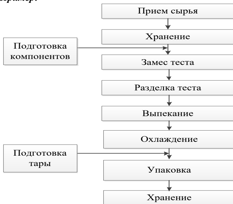
Рисунок 3.2 – Технологическая схема производства сдобных изделий
