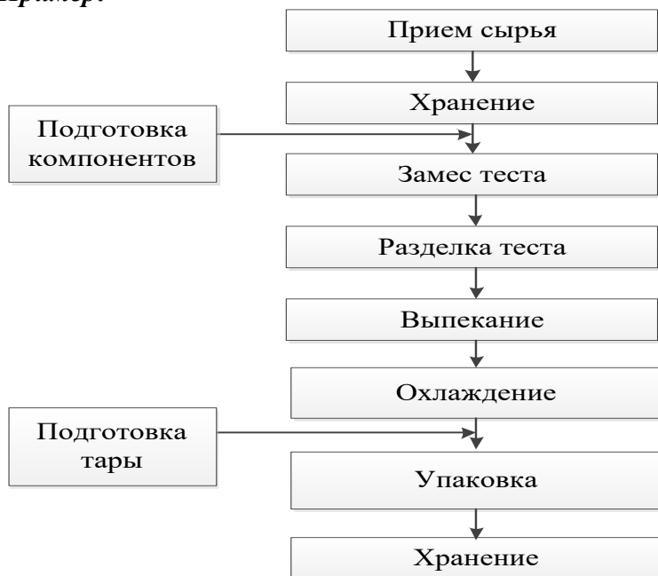
Рисунок 3.2 – Технологическая схема производства сдобных изделий
