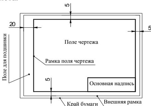
Рис. 2.8. Оформление поля чертежа
