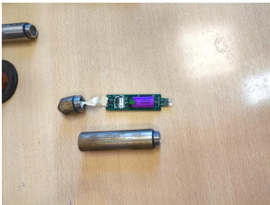
Рис. 1. Состояние датчика на момент первичной разборки
