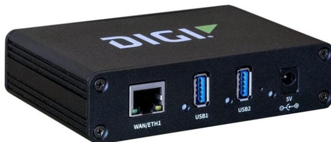
Рис. 4. Двухпортовый коммутатор Digi AnywhereUSB 2 Plus (обеспечивает виртуализацию двух портов USB)
