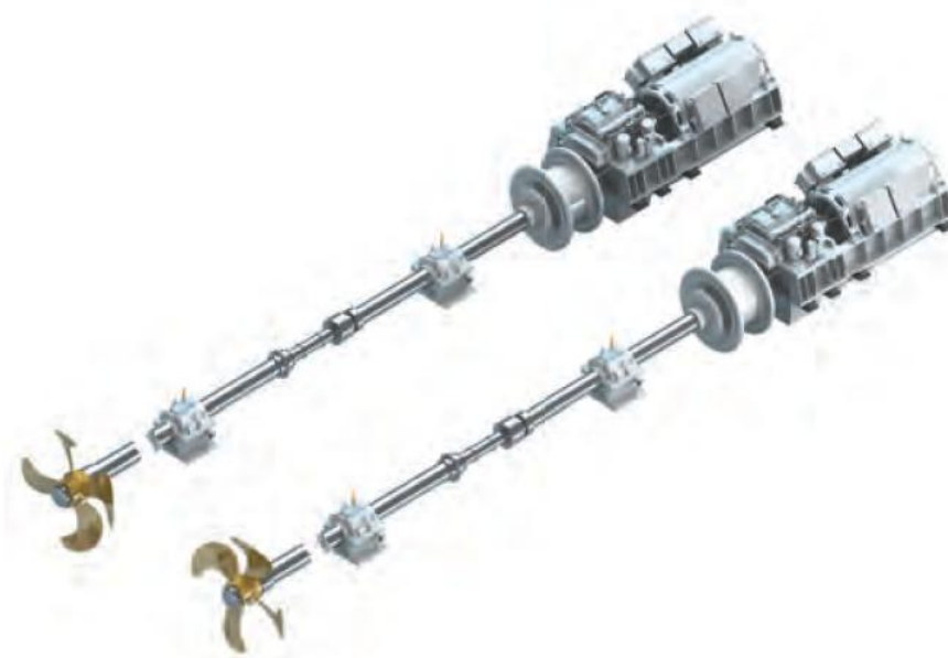
Рис. 4. Схема электродвижения с электрически управляемыми муфтами
