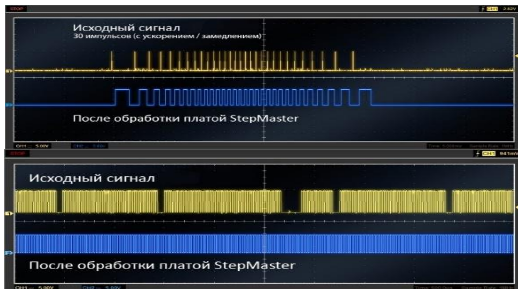
Рис. 3. Графики работы фильтров
