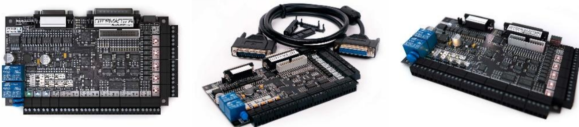
Рис. 2. Плата управления StepMaster ver 2.5
