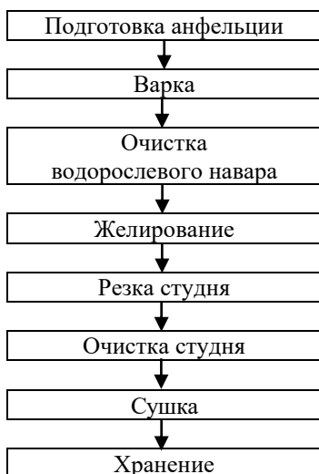
Рис.1. Технологическая схема получения агара тепловым способом
