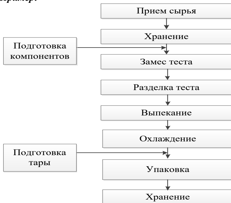
Рисунок 3.2 – Технологическая схема производства сдобных изделий
