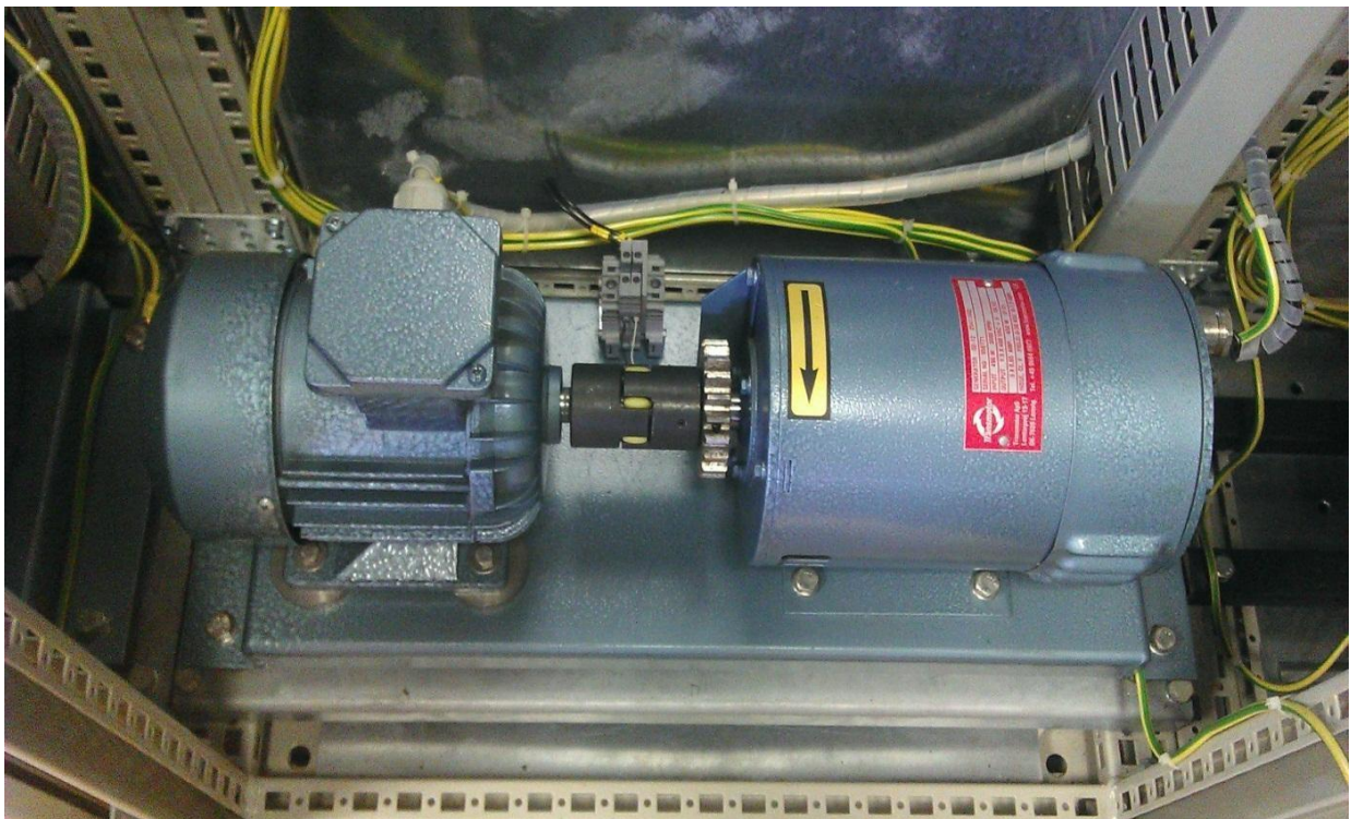
Рис. 8.6. Физическая модель дизель генератора
