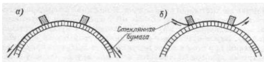
Рис. 5.3. Правильная (а) и неправильная (б) пришлифовка щеток.
