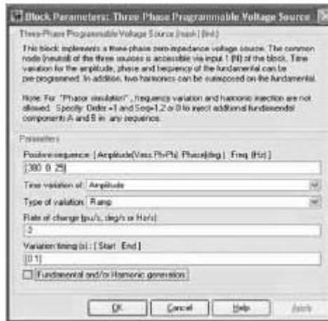
Рис.6.10. Программируемый источник противо ЭДС в нагрузке автономного инвертора напряжения.
