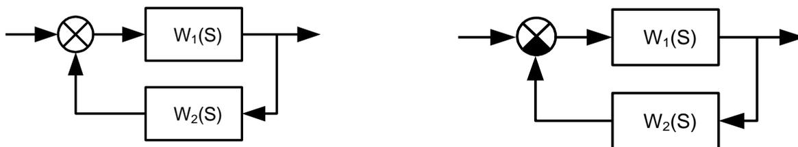
Рис. 3.4. Структурная схема соединения звеньев с обратной связью:
