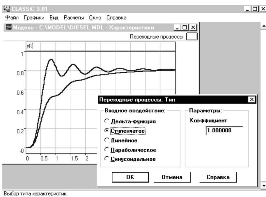
Рис.1.5. Графики переходных процессов и панель выбора входного воздействия.
