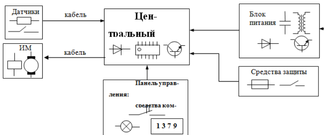
Рис.9.1 Структурная схема обобщенной электронной информационно измерительной системы.
