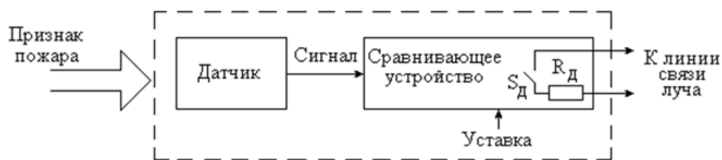
Рис.8.5. Структурная схема пожарного извещателя.
