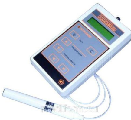
Рис. 1. Внешний вид нитратомера портативного «Нитрат-тест»
