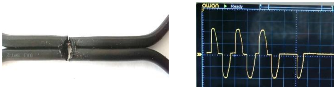
Рис. 6. Образец кабеля после завершения параллельного дугового пробоя и осциллограмма тока дуги при параллельном дуговом пробое
