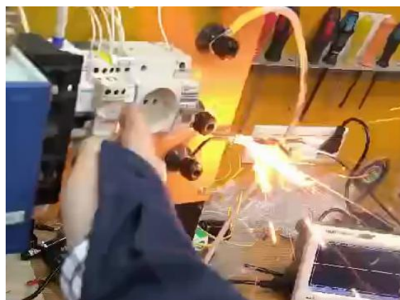
Рис. 5. Параллельный дуговой пробой на образце кабеля
