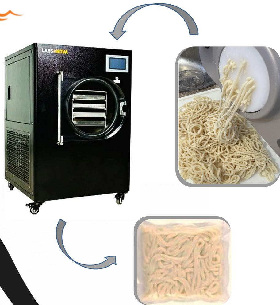
На начальном этапе необходимо оборудование: измельчитель для фарша, машина для изготовления макаронных изделий, лиофильная сушильная камера (или морозильный аппарат), вакуумный упаковщик
