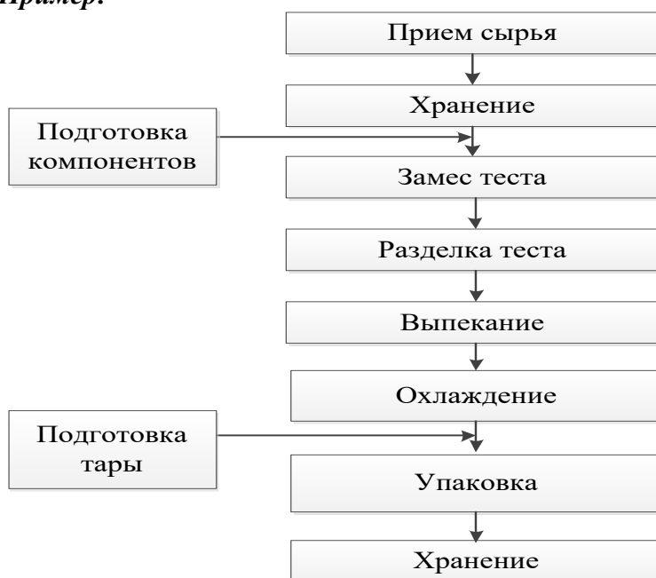
Рисунок 3.2 – Технологическая схема производства сдобных изделий
