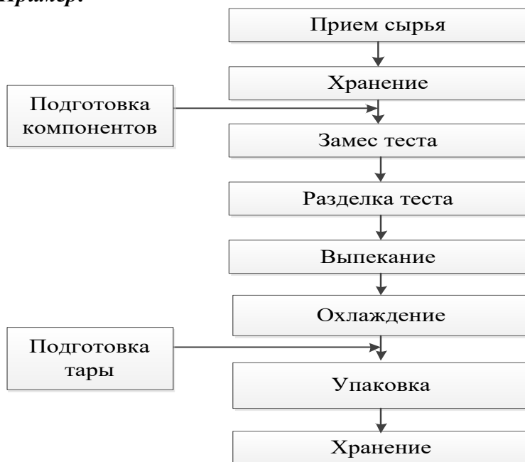
Рисунок 3.2 – Технологическая схема производства сдобных изделий
