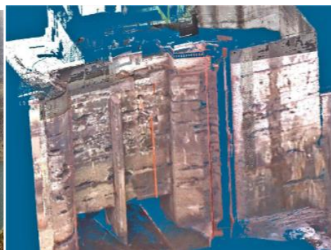
Рис. 4. Результаты сканирования камеры судоходного шлюза
