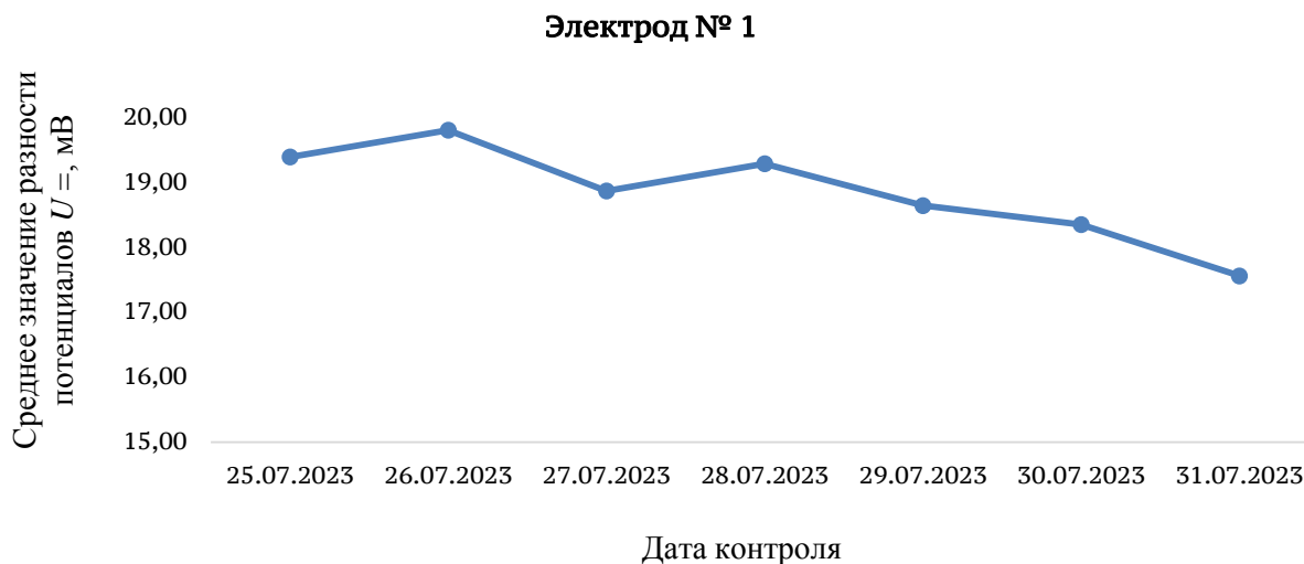
Рис. 2. Динамика результатов измерений разности потенциалов между ХСЭ (К) и ХСЭ (И) в период времени 25.07.23–31.07.23
