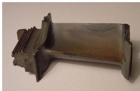
Рис. 3. Общий вид рабочей лопатки турбины с характерными повреждениями
