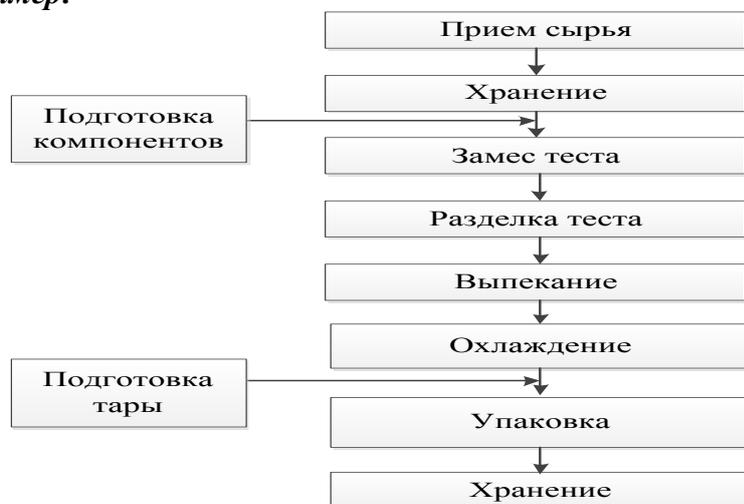
Рисунок 3.2 – Технологическая схема производства сдобных изделий
