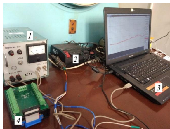
Рис. 2. Общий вид измерительной аппаратуры: 1, 2 – источники постоянного тока «Агат» и «БСП-5»; 3 – ноутбук; 4 – прибор АЦП-ЦАП 16/16 «SigmaUSB»
