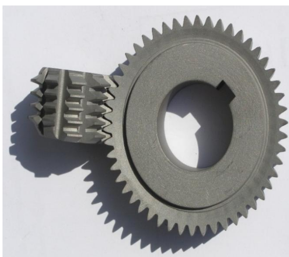
Рис. 3. Нарезание цилиндрического колеса
