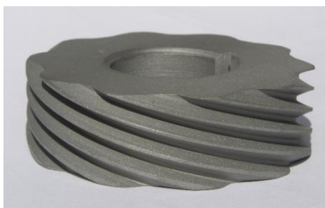
Рис. 1. Гиперboloидная винтовая зубчатая поверхность
