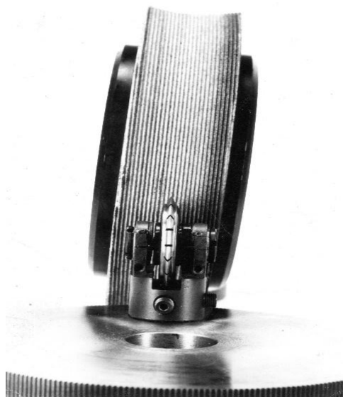
Рис. 4. Профилирование шлифовального круга
