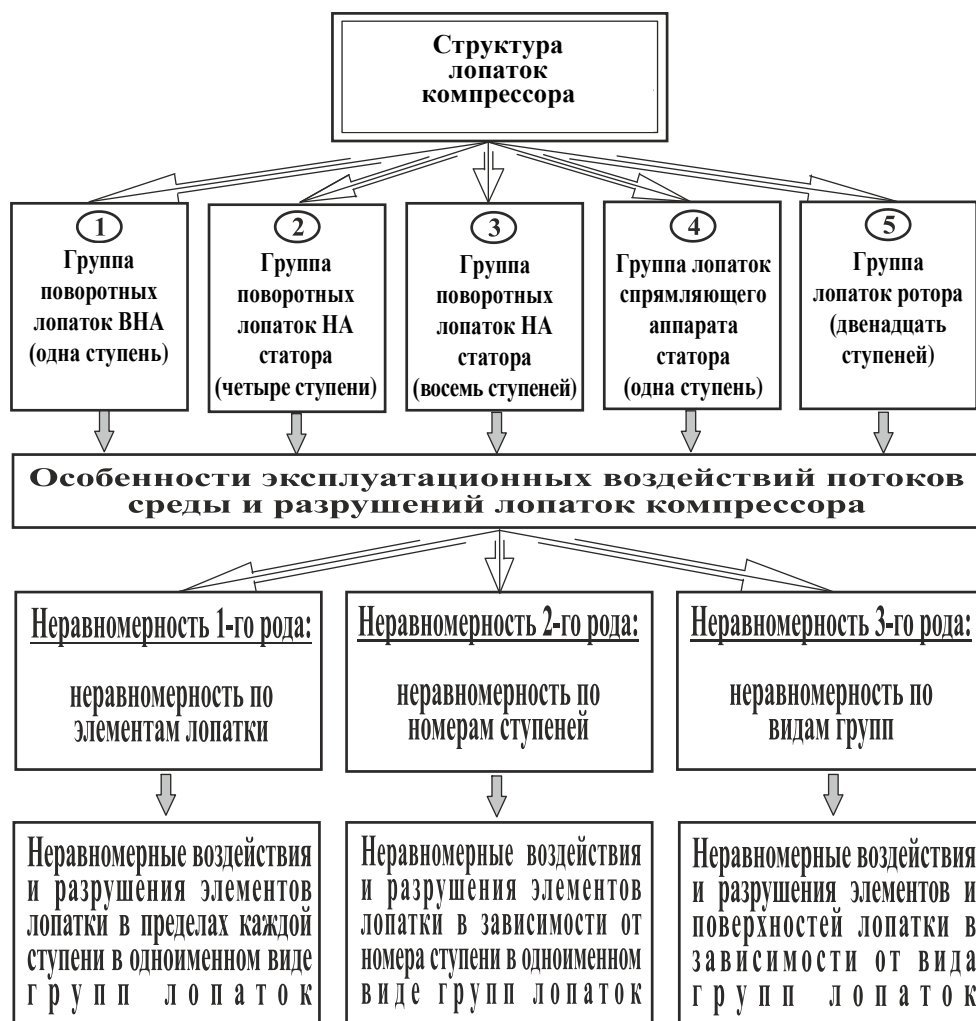
Рис. 4. Виды групп лопаток осевого компрессора ГТУ и особенности их разрушений
