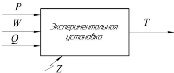
Рис. 5. Модель эксперимента «черный ящик»: P – прижимная сила; W – влажность поверхности трения; Q – загрязненность поверхности трения; T – тормозная сила; Z – неучтенные факторы (ошибка)
