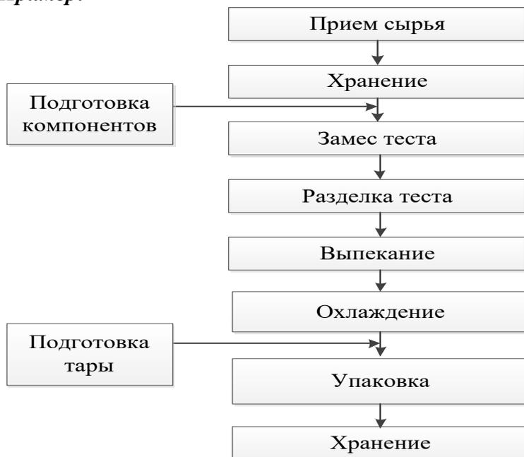
*Рисунок 3.2 – Технологическая схема производства сдобных изделий*
