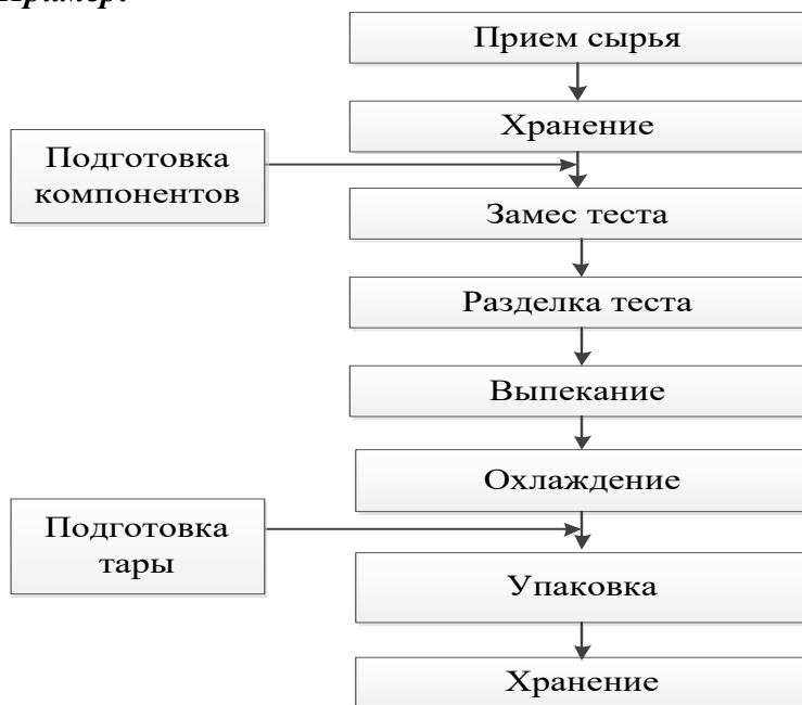
Рисунок 3.2 – Технологическая схема производства сдобных изделий
