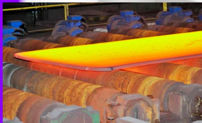
термического армирования получается при одностороннем ускоренном охлаждении толстолистового проката нагретого до температуры аустенитизации. В результате такой обработки одна сторона листа обладает большой твёрдостью и повышенной износостойкостью, а другая, имея более низкую твердость, хорошо подвергается механической обработке, например, резанием. Возрастает сопротивление стали на изгиб. Трещиностойкость при этом повышается на 20-30 %.
