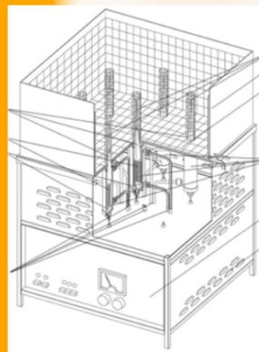
Конструкция аппарата позволяет плавно регулировать рабочую частоту генератора и излучателей в диапазоне от 22 до 44 кГц. Применение аппарата позволит сократить на 22-40 % продолжительности процесса посола, снизить удельную величину энергозатрат, повысить качество получаемого продукта.
