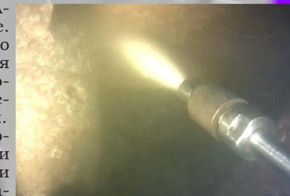
Благодаря разработанным кавитаторам удастся добиться высокой скорости качественной очистки поверхности и снизить требования к насосным установкам. Предложенная технология струйнокавитационной очистки функционирует при выходном давлении от 10 атм, что значительно уменьшает себестоимость услуги при коммерческом использовании нашего оборудования.
