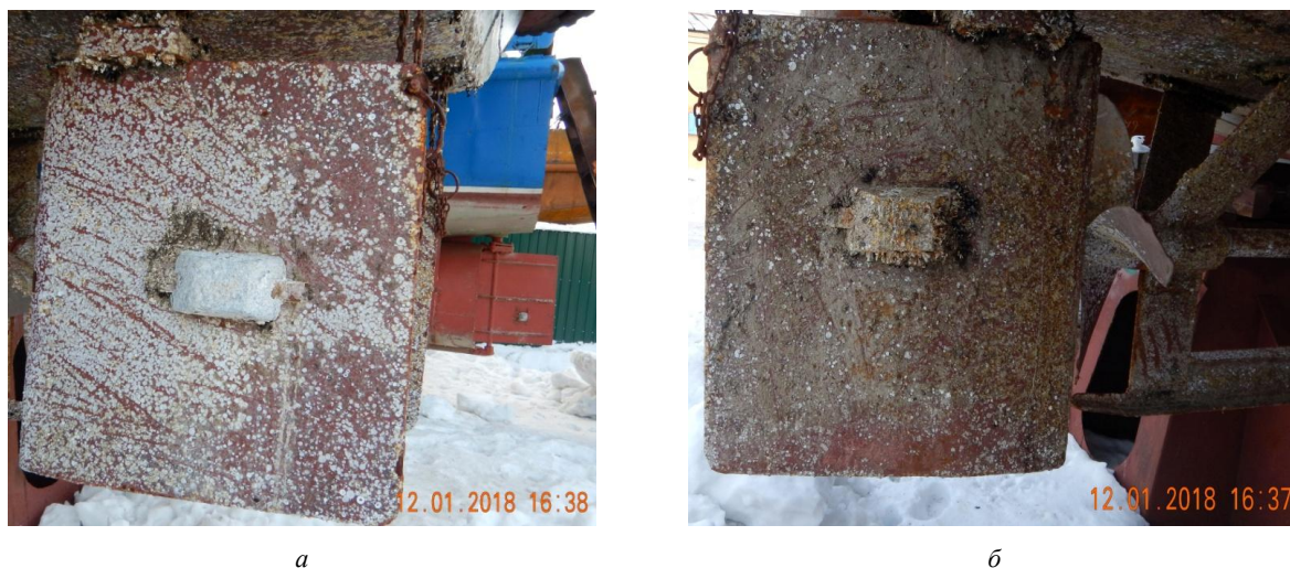
Рис. 2. Внешний вид протекторов на конструктивно схожем катере проекта 376: а – работоспособный протектор П-КОА-5 на левом пере руля, не покрытый биообрастанием и растворившийся в морской воде; б – неработоспособный протектор П-КОА-5 на правом пере руля, оброс баянусами и мидиями, в морской воде не растворялся
