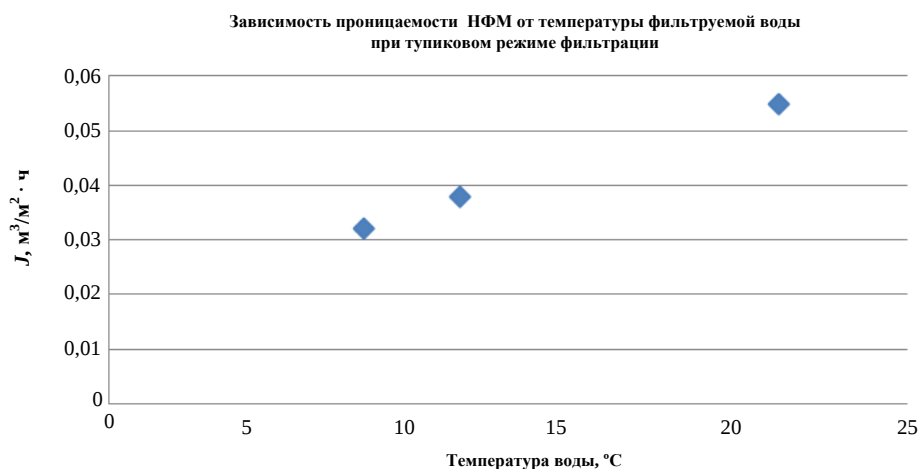
Рис. 6. Зависимость проницаемости НФМ от температуры фильтруемой воды при тупиковом режиме фильтрации
