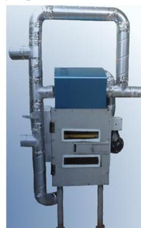
Рис. 2. Малогабаритная сушильная установка
