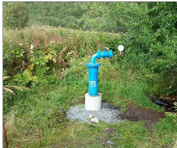
*Рис. 5. Наблюдательная скважина №73 в августе 2016 г. при проведении гидрогеологического мониторинга*
