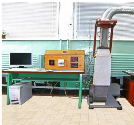
Рис. 1. Экспериментальная установка для исследования процесса сушки мяса рапаны в псевдооживленном слое
