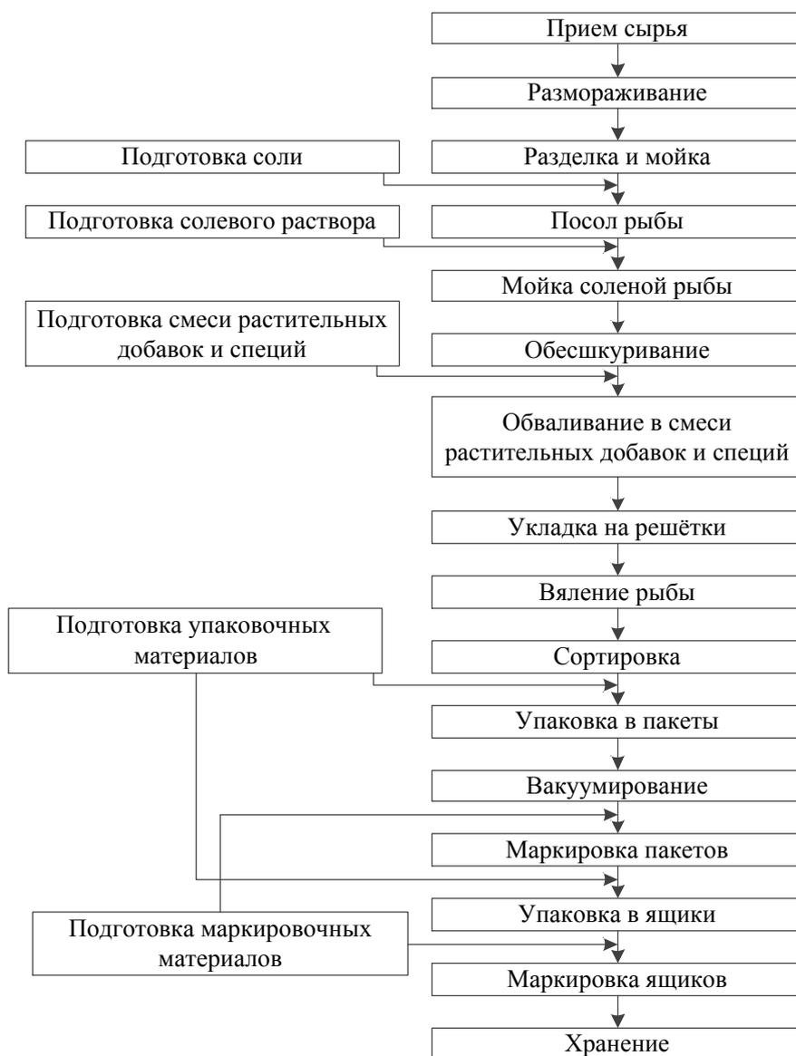
Технологическая схема производства филе камбалы вяленого с растительными добавками
