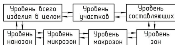
Рис. 3. Уровни глубины технологии или уровни деления изделия, реализации технологических воздействий и обеспечения свойств изделия
