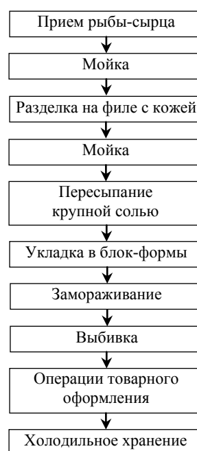
Рис. 3. Технологическая схема производства малосоленой продукции из лососевых сухим низкотемпературным посолом с использованием крупной соли
