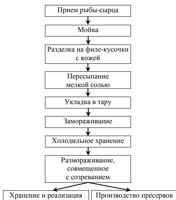
Рис. 2. Технологическая схема производства малосоленой продукции из лососевых сухим низкотемпературным посолом с использованием мелкой соли
