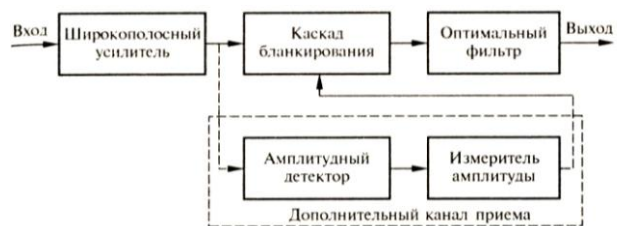
Рис. 10. Структурная схема селекции по периоду следования импульсов
