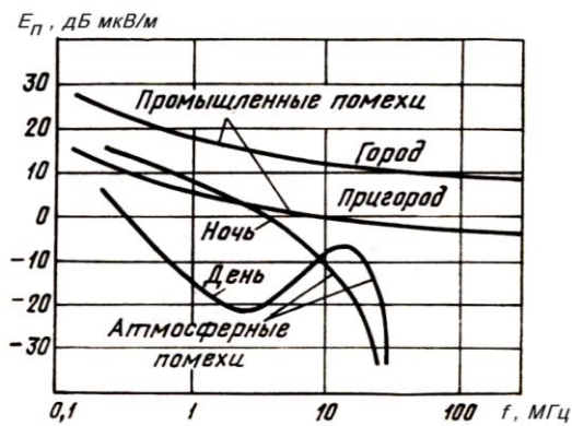
Рис. 2. Зависимость напряженности поля атмосферных и промышленных помех от частоты
