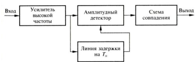
Рис. 9. Структурная схема бланкирования приемника
