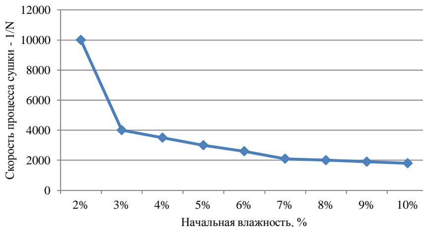
Рис. 4. Зависимость скорости процесса сушки от начальной влажности материала пробы
