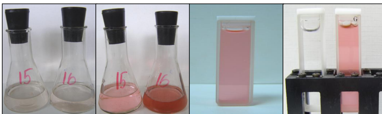
Рис. 5. Водные экстракты красных водорослей: а – сырых неизмельченных; б – сырых измельченных в блендере, в – воздушно-сухих дезинтегрированных красных водорослей; г – воздушно-сухих дезинтегрированных (справа) и раствор сравнения (слева)
