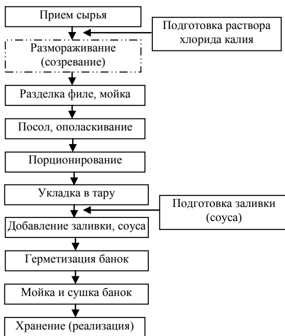
Рис. 2. Технология производства пресервов с использованием нового способа созревания
