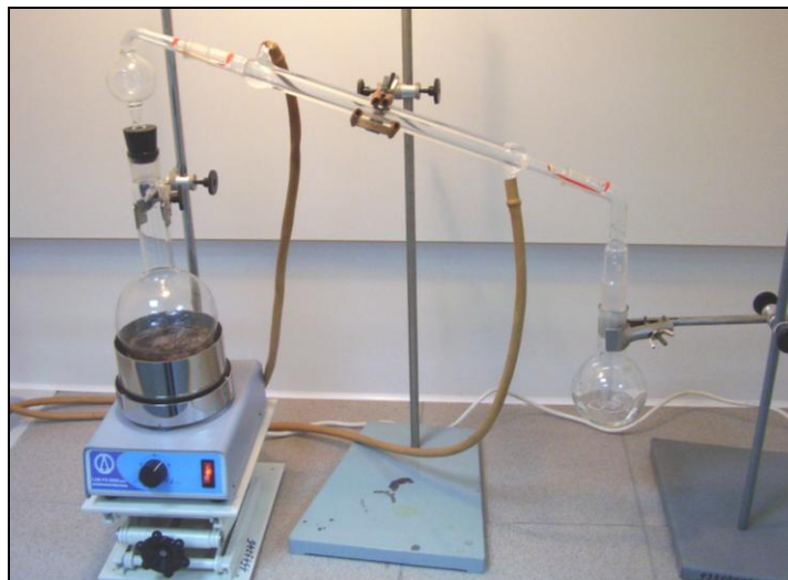
Рис. 3. Отгонная установка, применяемая при определении массовой доли белка
