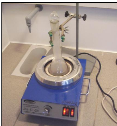
Рис. 1. Нагревание содержимого колбы Кельдаля в колбонагревателе при определении массовой доли белка
