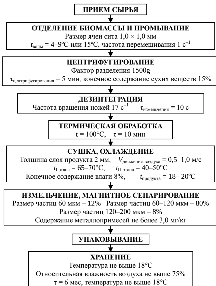
Рис. 3. Технологическая схема получения пищевого порошка из термофильных синезеленых водорослей рода Phormidium
