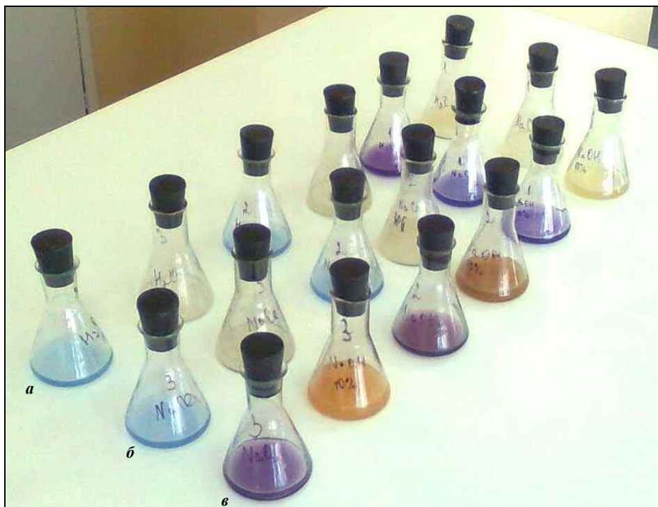
Рис. 4. Окрашенные экстракты для спектрофотометрического определения белковых фракций: а – водорастворимой, б – солерастворимой, в – щелочерастворимой
