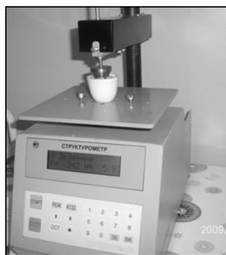
Рис. 3. Структурометр СТ-1М
