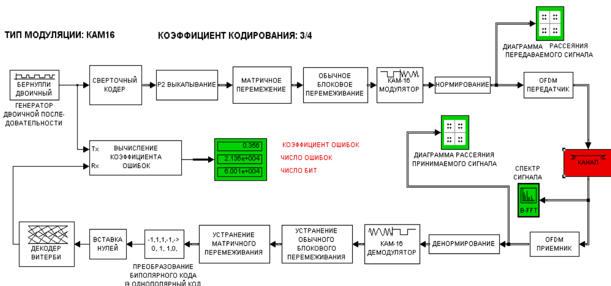
Рис. 6. Схема измерителя коэффициента ошибок при передаче информации по цифровому каналу связи
